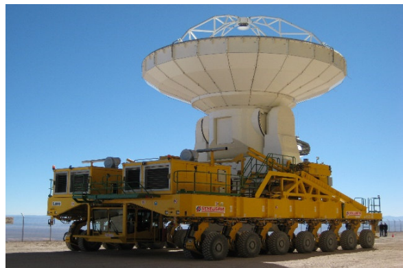
Bilder 5 und 6 ALMA-Antennenanlage und eine der 12 m-Antennen auf dem Transporter „Lore“ 8
