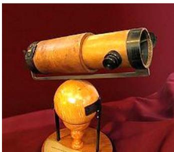
**Bild 4** Newtons Spiegelteleskopmodell von 1672 für die Royal Society (Nachbildung) <sup>1</sup>
