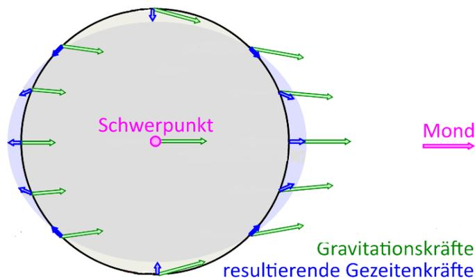
**Bild 2** Gezeitenbeschleunigung (blau) durch den Mond für Orte an der Erdoberfläche als Differenz der örtlichen Gravitationsbeschleunigung (grün) und der Beschleunigung des Massenmittelpunktes <sup>2</sup>
